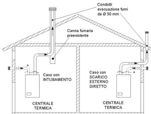
**Figura 2:** rappresentazione schematica di scarico fumi ed aspirazione aria comburente per una FUTURA 38.
