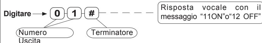
**Comando dell'Uscita: per disattivarla il comando e' "0", per attivarla il comando e' "1", per far muovere l'uscita in modo impulsivo il comando e' "2"**
