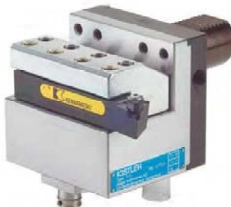
Figura 3.16. Dinamometro piattaforma Kistler 9121 per misura forze di taglio in tornitura, compatibile con montaggio della struttura utensile-portautensile su torretta girevole di un tornio CN.
