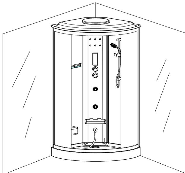
Gli attacchi idrici, si trovano dietro al miscelatore ad una altezza di 120 cm circa, si tenga conto che in ingresso la doccia si collega tramite 2 comuni flessibili (attacco da 1/2 pollice) ai tubi acqua calda e fredda senza particolari predisposizioni. Lo scarico è rialzato rispetto al pavimento di modo da collegarsi allo scarico sul pavimento tramite un comune tubo flessibile
