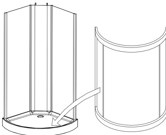
4. Installare la struttura a vetri sulla base, usare viti per fissare il pannello posteriore e la struttura di vetro.
