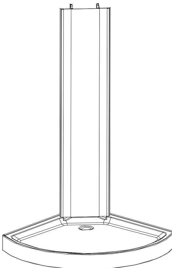
**Fase 4: Collegamento dei pannelli posteriori e della base.** Mettere il pannello posteriore sulla vasca, poi usare le viti M6x25 per fissarli seguendo i fori. In caso i fori non coincidano praticarne di nuovi o allargare i presenti.
