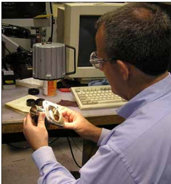
Controllo profilometrico della finitura superficiale della valvola
