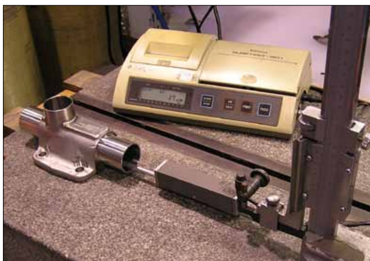
Controllo profilometrico della finitura superficiale della valvola
