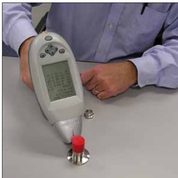
Prova d'identità della lega
