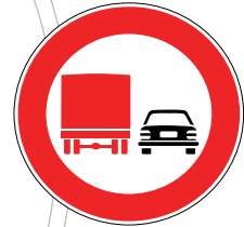
Figura II 52 Art. 117 DIVIETO DI SORPASSO PER I VEICOLI DI MASSA A PIENO CARICO SUPERIORE A 3,5 t
