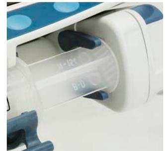
7. Verificare che il tipo e le dimensioni della siringa corrispondano a quelli visualizzati sulla pompa quindi premere **CONFERMA**. Se necessario, è possibile modificare il tipo di siringa premendo il tasto di programmazione **TIPO**.
