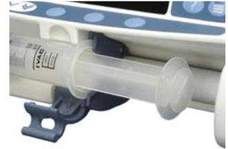
4. Sollevare il morsetto blocca siringa fino a bloccarlo sul cilindro della siringa.
