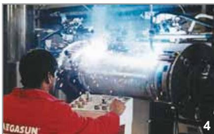
Robot saldatura coperchi
