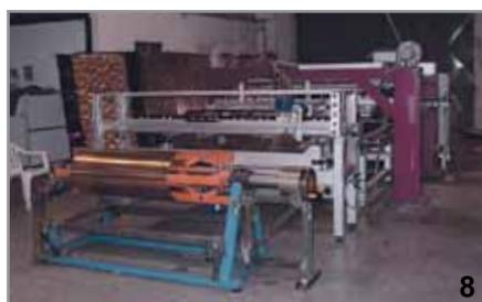
Sistema automatico di formazione e saldatura ad ultrasuoni degli assorbitori
