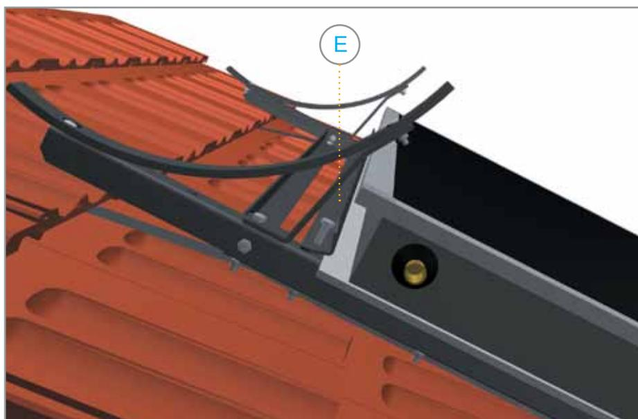
Applicare l'elemento "E" superiore agli elementi "B", **avvitando strettamente** i relativi bulloni, in modo da fissare bene il collettore o i collettori.
