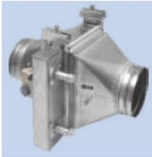
**TPO**, post-riscaldatore da installare all'esterno dell'unità, idronico, con valvola miscelatrice alimentazione 24V, controllo 0-10V, e un sensore di temperatura mod. ADS 120 (solo nelle unità con sistema di controllo digitale ".D") da installare sul canale di mandata aria ambiente.
