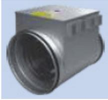
**EPO-V**, riscaldatore elettrico da installare all'esterno dell'unità sul condotto di alimentazione aria esterna come pre-riscaldatore o sul canale di mandata aria ambiente come post-riscaldatore in abbinamento al sensore di temperatura mod. ADS 120 (solo nelle unità con sistema di controllo digitale ".D");
