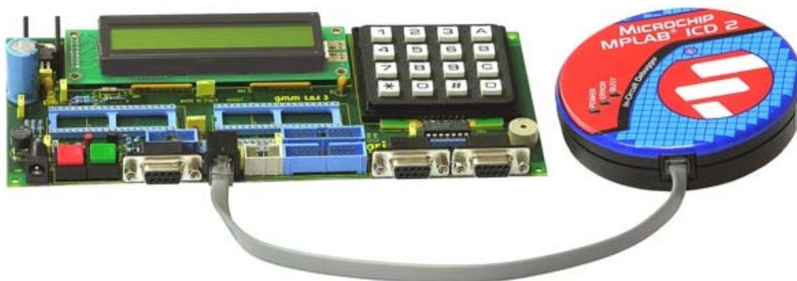
FIGURA 25: COLLEGAMENTO TRA GMM TST 3 E MPLAB™ ICD 2
