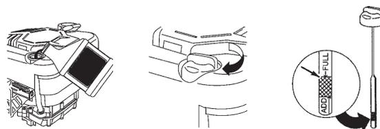
**REMARQUE :** Lorsqu'il faut ajouter de l'huile au carter du moteur, utilisez une huile détergente de haute qualité, de grade SAE 30 et de catégorie 'Pour service SF, SG, SH'. N'utilisez aucun additif spécial. Choisissez la viscosité de l'huile selon les températures prévues lors de l'utilisation de l'appareil.
