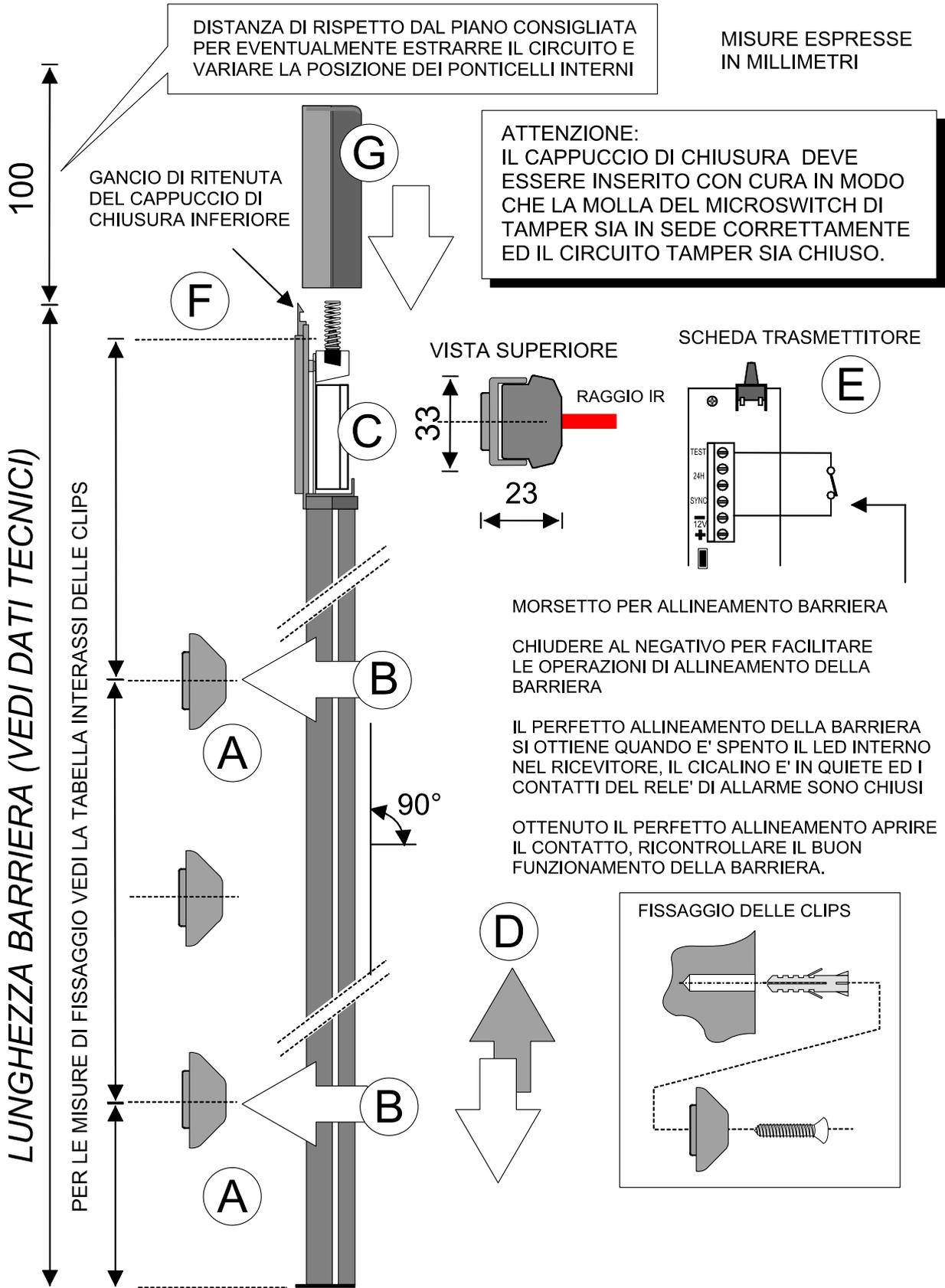
Tabella per il posizionamento ed il fissaggio delle clips di sostegno delle barriere
