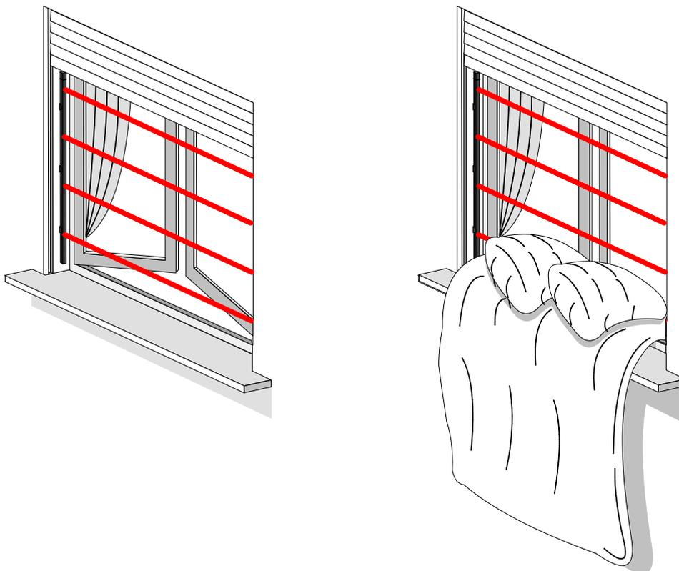
In questo caso si avrà la segnalazione dello stato di allarme per oscuramento del fascio inferiore, tramite la segnalazione ottica ed acustica nel ricevitore, mentre la condizione di allarme sarà trasferita alla centrale per la gestione corrispondente.
