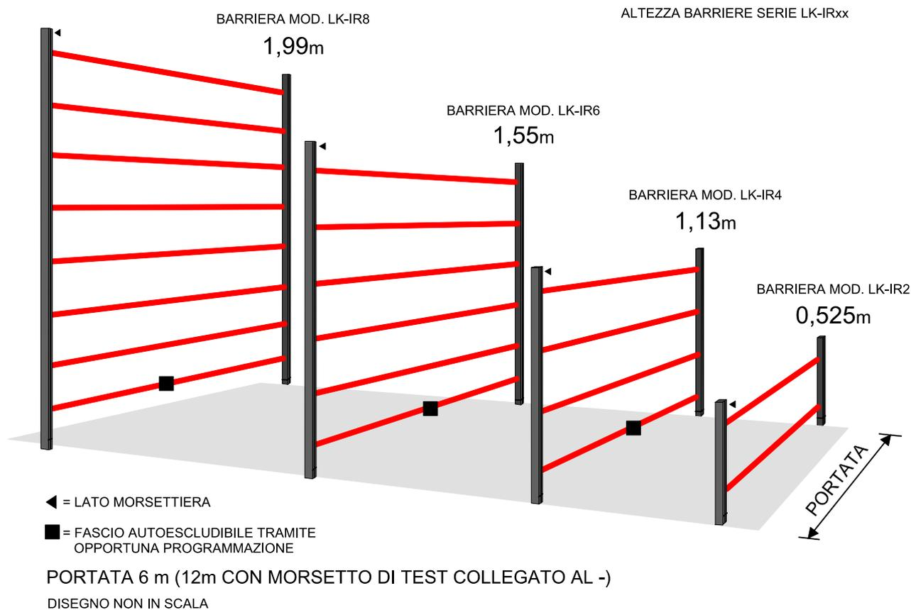
**NOTA:** L'installazione delle barriere con la morsettiera di collegamento verso il basso assicura il grado di protezione IP53, l'installazione con la morsettiera verso l'alto assicura il grado di protezione IP55.
