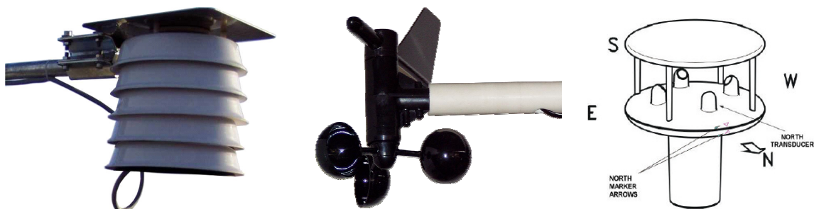
Fig. 2 - Testa sensori (gabbia meteorologica), anemometro Davis e anemometro sonico.
