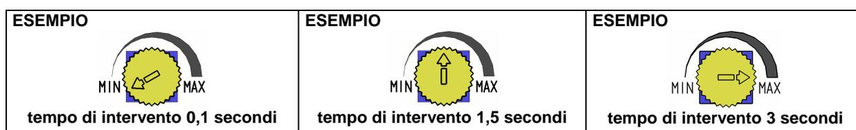
**Se il trimmer OBS è in posizione di MAX, si esclude il rilevamento ostacolo.**
