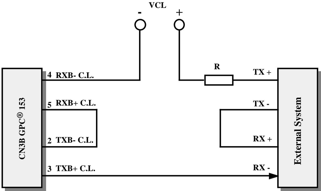
FIGURA 11: ESEMPIO DI COLLEGAMENTO PUNTO PUNTO IN CURRENT LOOP A 2 FILI
