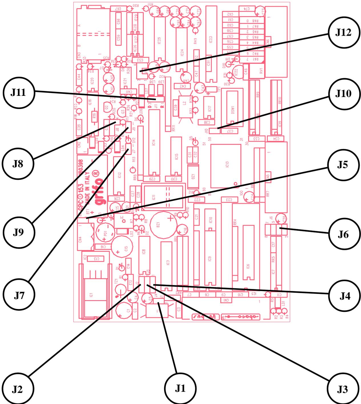
FIGURA 23: DISPOSIZIONE JUMPERS LATO COMPONENTI
