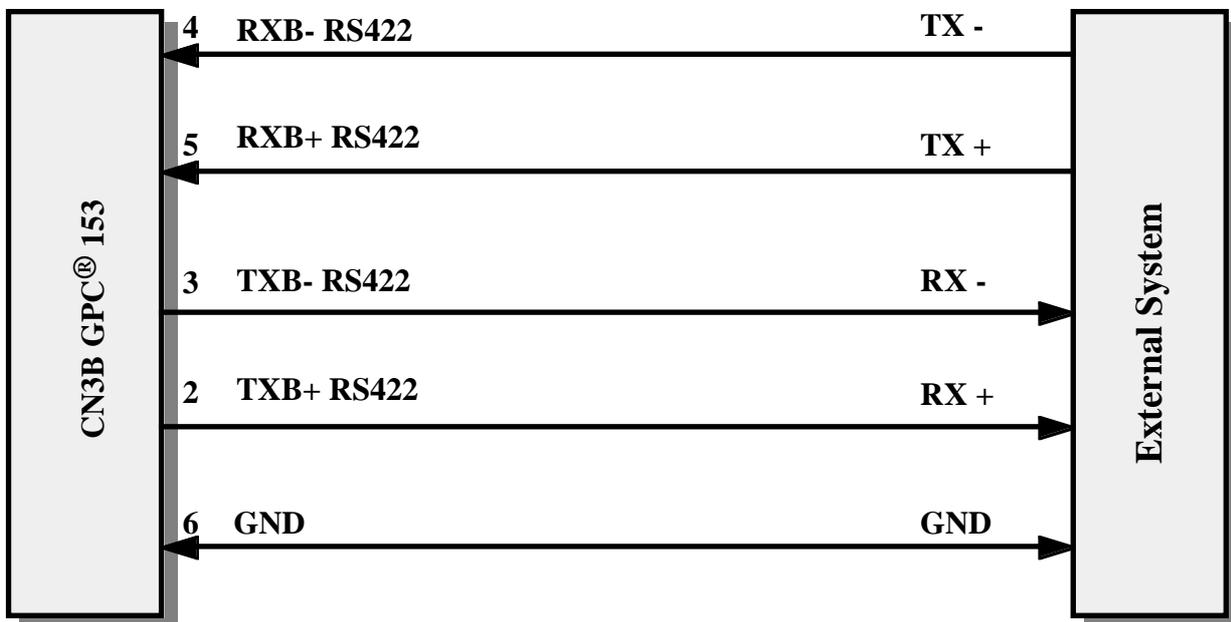
FIGURA 8: ESEMPIO DI COLLEGAMENTO PUNTO PUNTO IN RS 422
