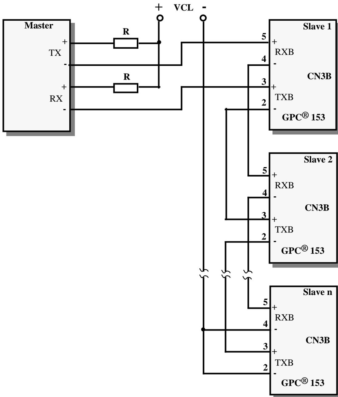
FIGURA 13: ESEMPIO DI COLLEGAMENTO IN RETE IN CURRENT LOOP PASSIVO
