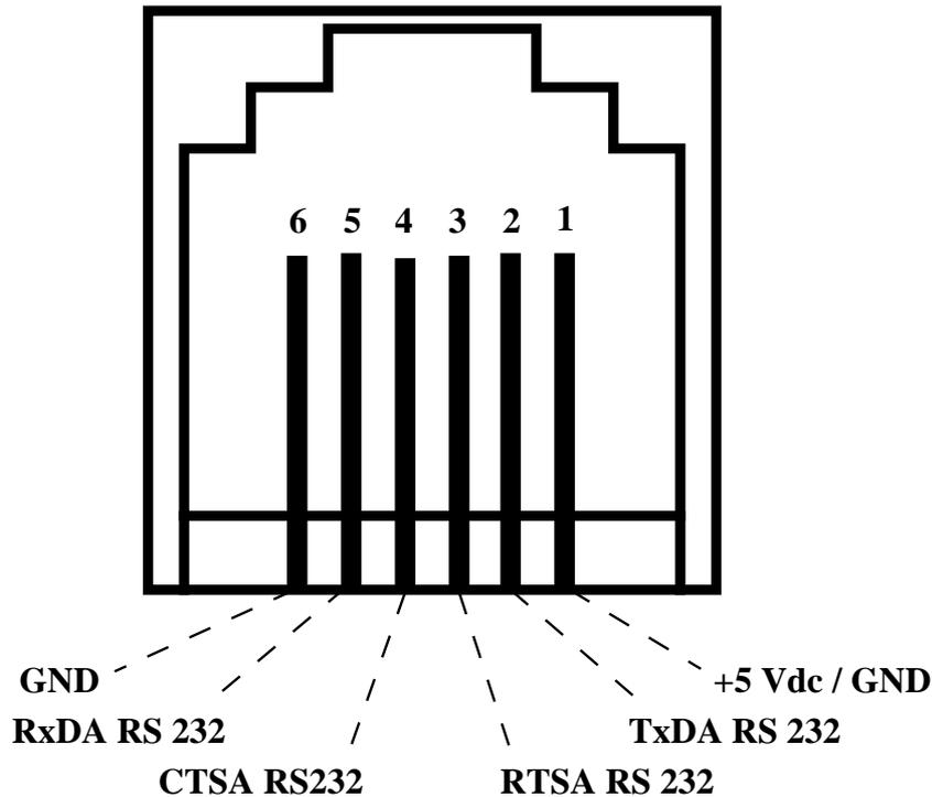
FIGURA 5: CN3A - CONNETTORE PER COMUNICAZIONE SERIALE A
