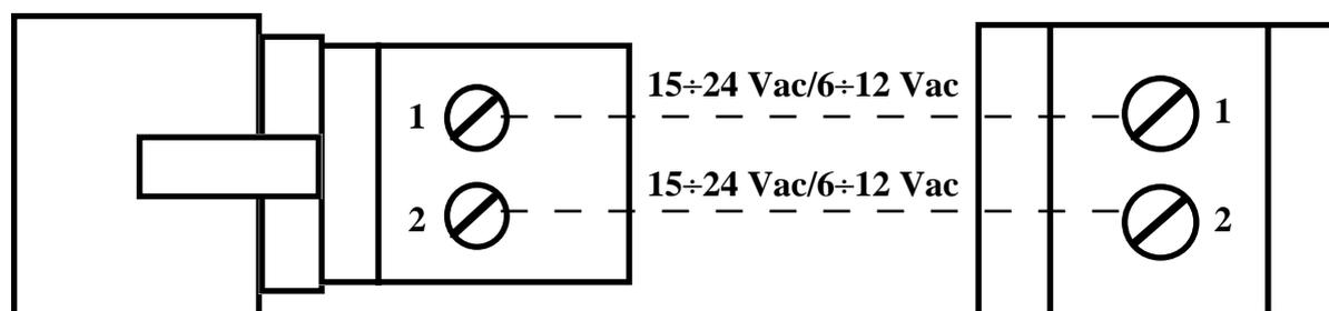
**FIGURA 3: CN2 - CONNETTORE ALIMENTAZIONE CON SEZIONE ALIMENTATRICE**
