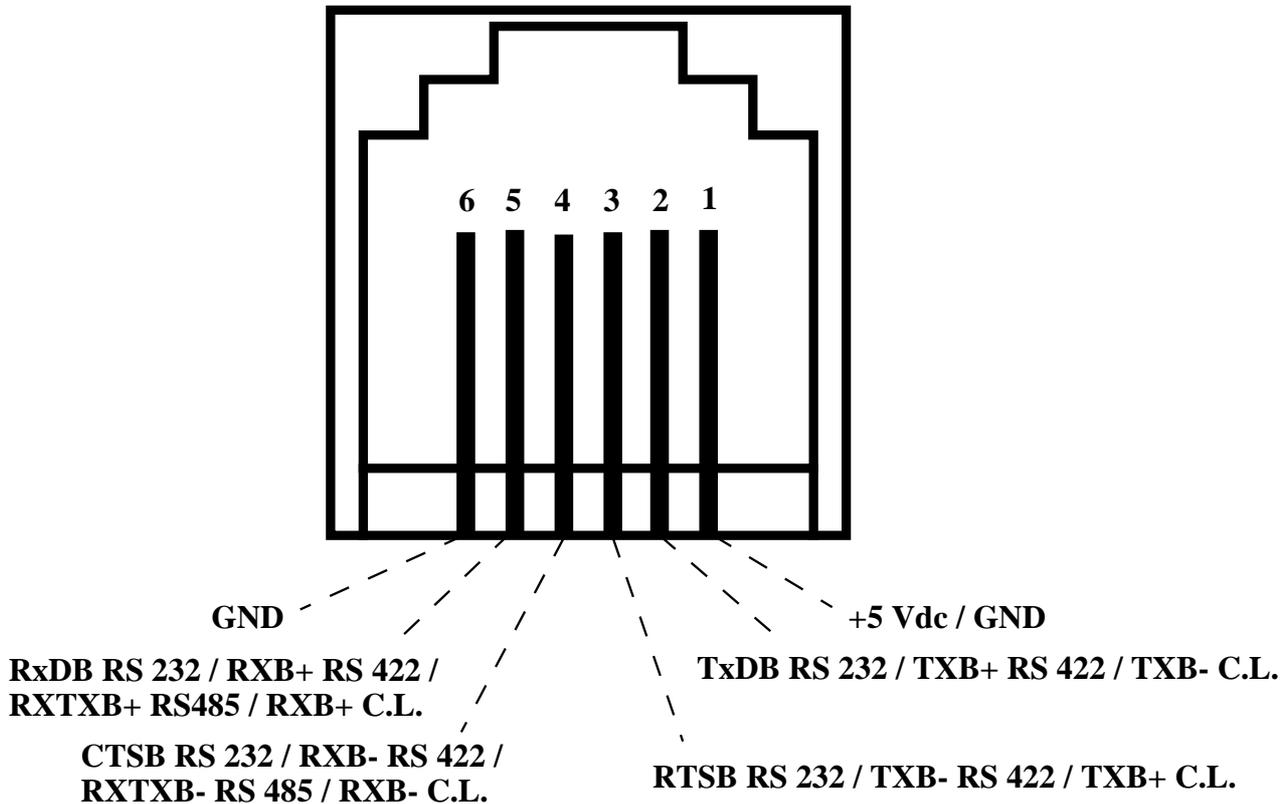
FIGURA 14: CN3B - CONNETTORE PER COMUNICAZIONE SERIALE B
