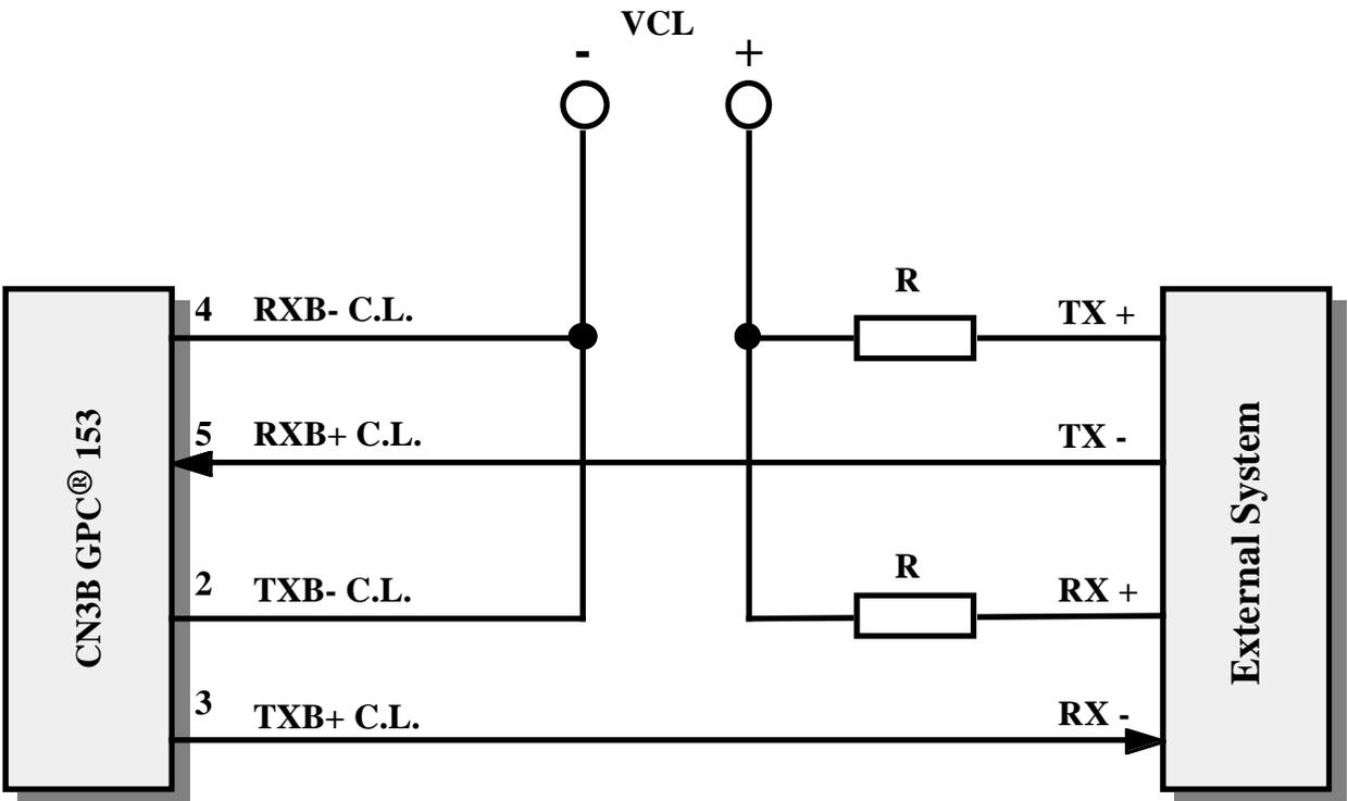
FIGURA 12: ESEMPIO DI COLLEGAMENTO PUNTO PUNTO IN CURRENT LOOP A 4 FILI
