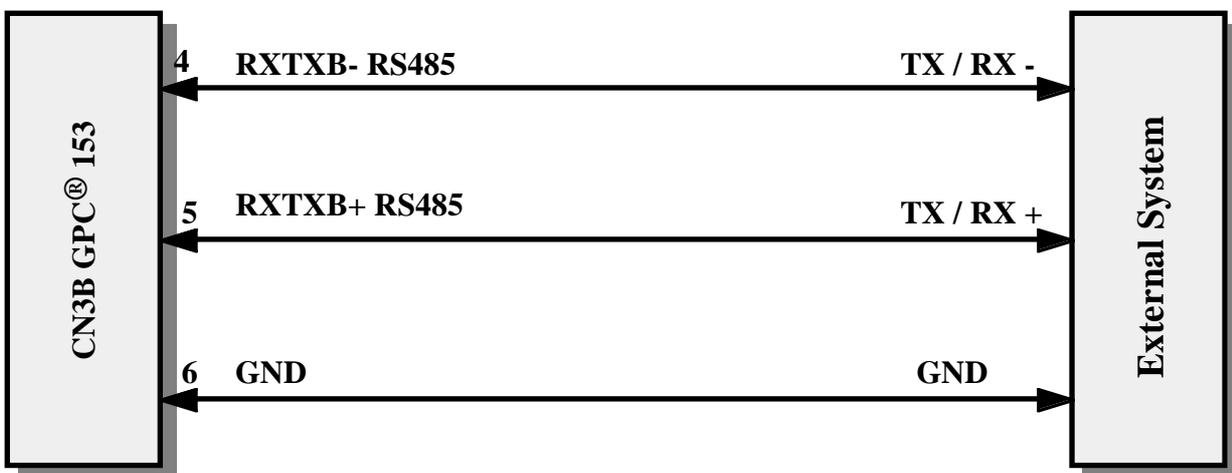
FIGURA 9: ESEMPIO DI COLLEGAMENTO PUNTO PUNTO IN RS 485
