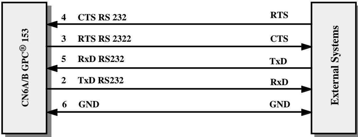
FIGURA 7: ESEMPIO DI COLLEGAMENTO PUNTO PUNTO IN RS 232
