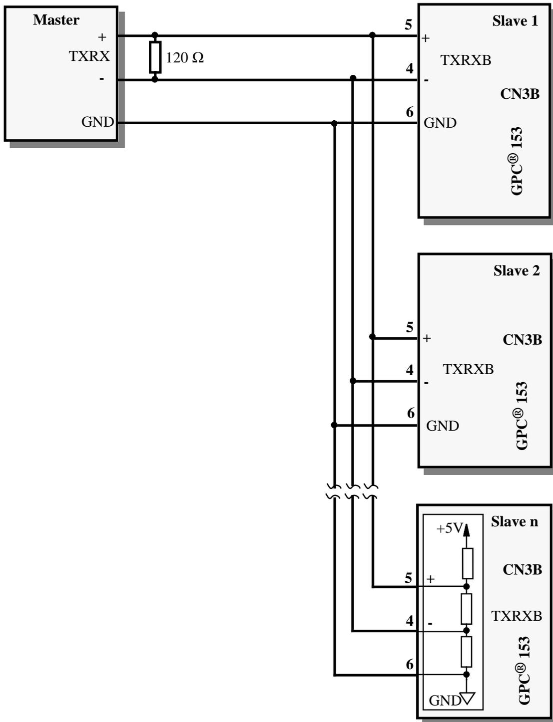
**FIGURA 10: ESEMPIO DI COLLEGAMENTO IN RETE IN RS 485**
