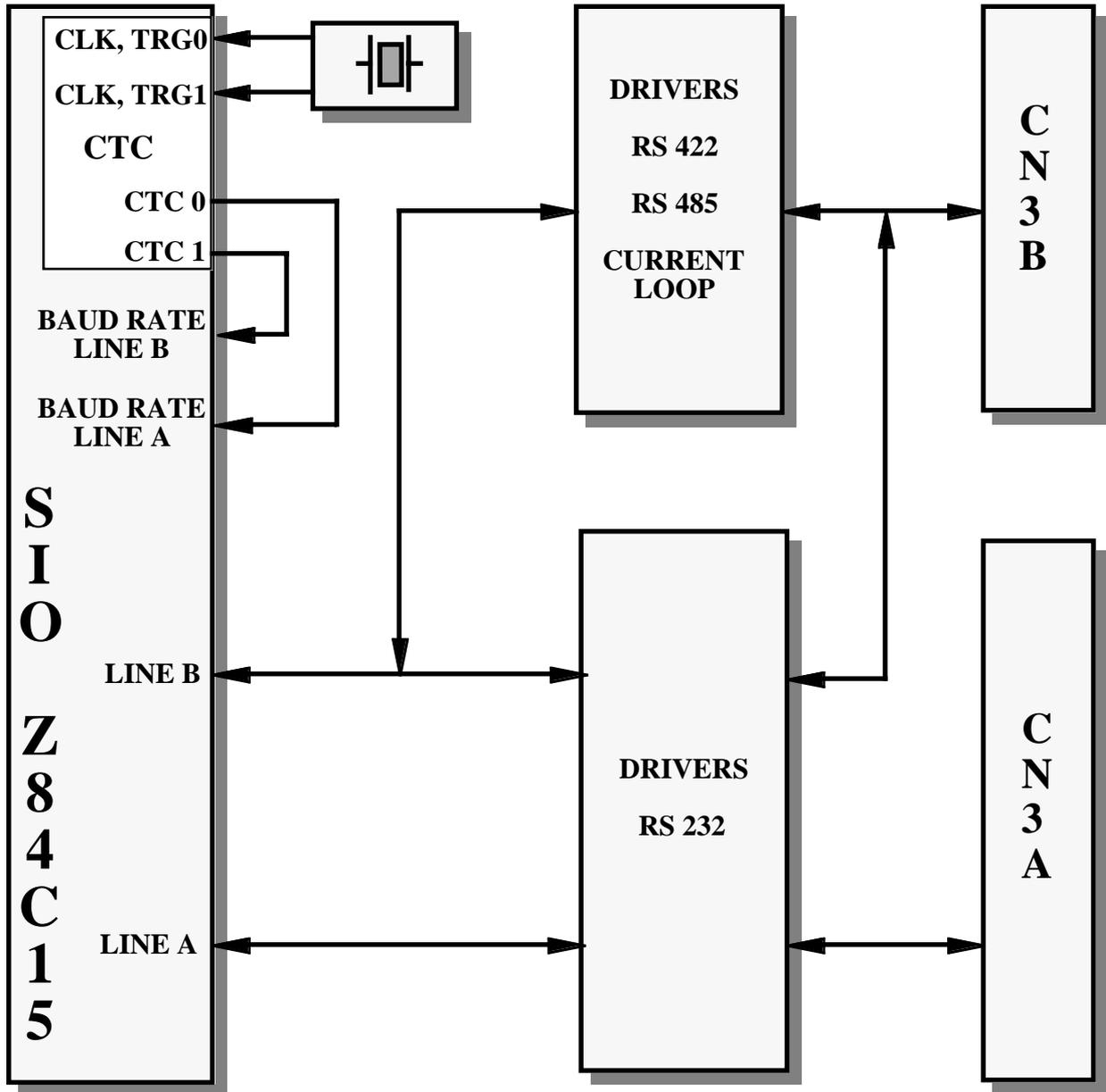
FIGURA 6: SCHEMA DI COMUNICAZIONE SERIALE
