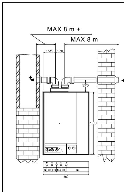
N.B.: La somma della lunghezza del tubo di scarico e quella del tubo di aspirazione non deve superare i 16 metri. Per ogni curva aggiunta la lunghezza massima consentita deve essere diminuita di 1 metro.
