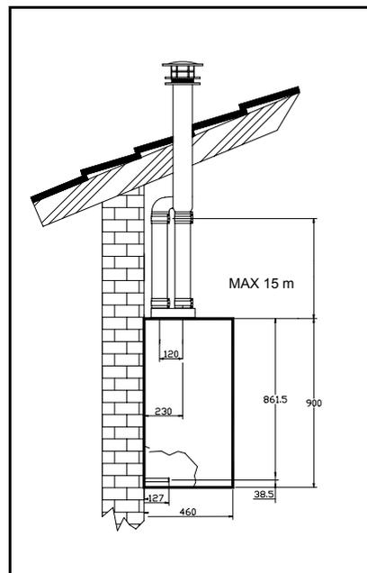
1. N.B.: In tutte le configurazioni di scarico fumi installare la caldaia ad una distanza di almeno 40 cm tra la parte superiore della stessa e il soffitto per poter estrarre l'anodo del bollitore.
