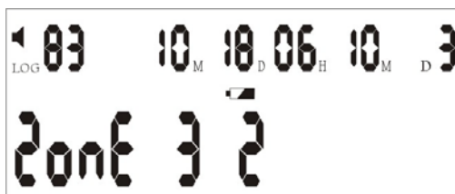
Fig. 25: rilevatore nr.2 in zona 3 è quasi scarico
