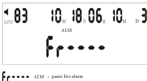
Fig.15: L'LCD mostra quando c'è un allarme antincendio
