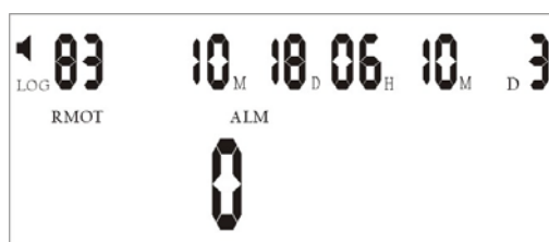
Fig.13: L'LCD indica un allarme antipanico attivo
