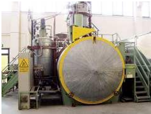
Impianto di inglobamento in resina con stoccaggio e miscelazione
