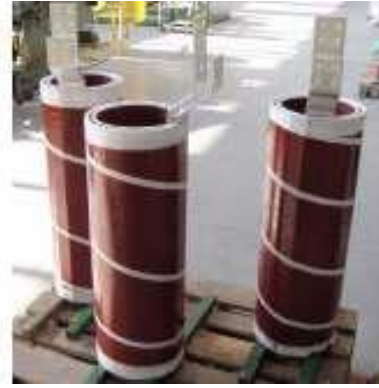
Avvolgimento B.T. per trasformatore in resina
