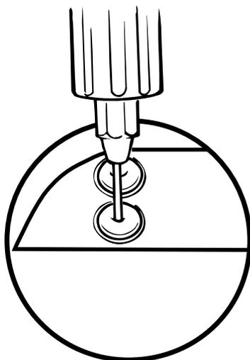
2. Spingere il pin di connessione dell'elettrocatetere nella porta del connettore finché il pin del connettore non sia visibile nell'area di visualizzazione dell'elettrocatetere. È possibile utilizzare acqua sterile come lubrificante. Non è necessario utilizzare del sigillante.
