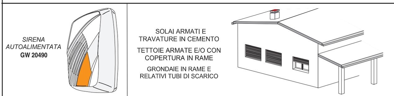
Nella seguente figura sono indicate, come esempio, delle posizioni d'installazione ove il ricevitore della sirena potrebbe essere condizionato dalla grande dimensione pensile del tetto, da una tettoia e dalle relative grondaie in rame. Queste fonti di disturbo possono ridurre ulteriormente la portata del ricevitore della sirena, in certi casi con effetto immediato in altri progressivamente nel tempo.
