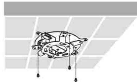
3. Montare il corpo della EL-DOME sulla staffa e ruotarlo in senso orario con aggancio a baionetta. Assicurarsi che il foro per la vite sul fianco della telecamera sia allineato con la staffa.
