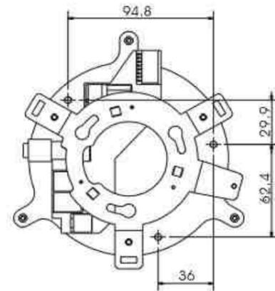
2. Fissare, con le tre viti, la staffa al soffitto.
