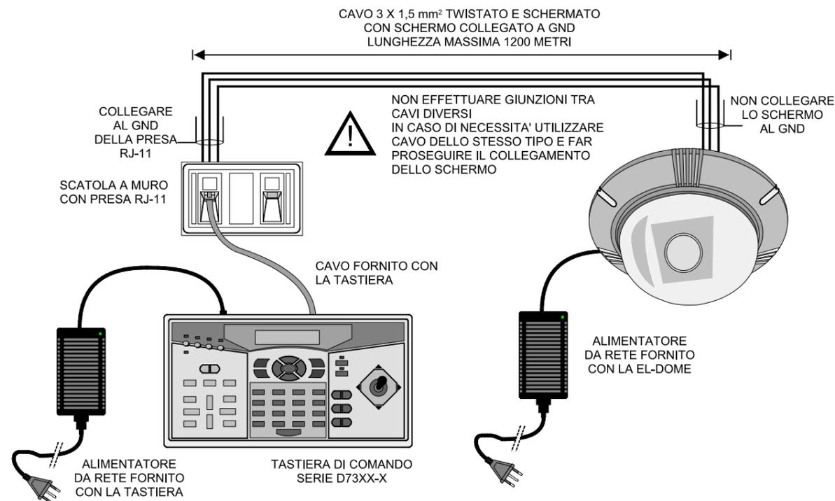
**Nota:** Nel collegamento sono stati utilizzati i morsetti -D, +D e GND e protocollo HALF DUPLEX, per semplicità non è stato disegnato il cavo video.
