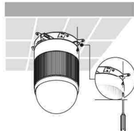
4. Fissare la vite per bloccare il corpo della telecamera evitando.
