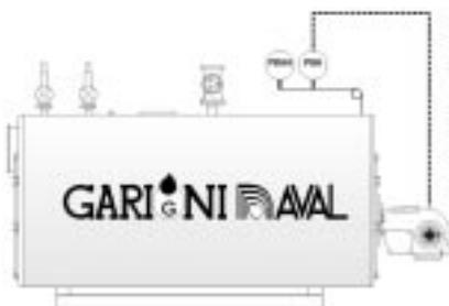
PSH= pressostato di regolazione monostadio
