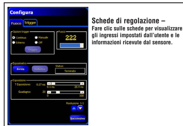
Figura 4-9. Finestra Configurazione
