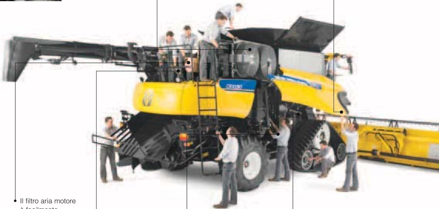
Il filtro aria motore è facilmente accessibile dalla piattaforma motore.
