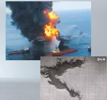
Le termocamere FLIR sono particolarmente utili per rilevare sversamenti di greggio, galleggianti sull'acqua.
