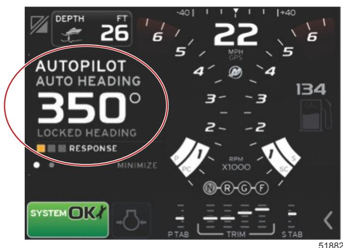
5. Per correggere la rotta mentre la modalità di rotta automatica è attiva fare riferimento a **Correzione della rotta per mezzo dei pulsanti di virata o della leva di comando**.
