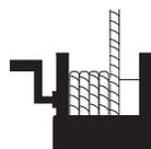
Non utilizzare la macchina se con il carrello in posizione abbassata non vi sono almeno 4 spire di cavo sul tamburo del verricello.
