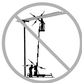
Mantenere la distanza di sicurezza dalle linee e dalle apparecchiature ad alta tensione secondo le vigenti normative nazionali e in base alla seguente tabella.
