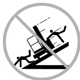
Usare buon senso e una pianificazione razionale per controllare gli spostamenti della macchina posizionata in prossimità o su piani inclinati.
