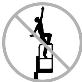
Non uscire dalla piattaforma quando è in posizione sollevata. In caso di interruzione dell'alimentazione, è necessario disporre di personale a terra per azionare la valvola di abbassamento manuale.
