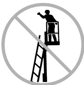
Non posizionare scale o ponteggi all'interno della piattaforma o contro qualsiasi parte della macchina
