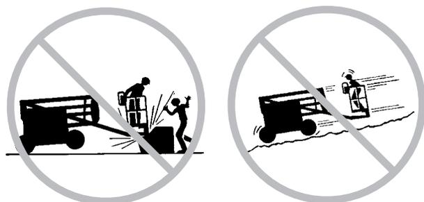
Ridurre la velocità di traslazione in base alle condizioni del suolo, del traffico, alle pendenze, alla presenza di personale e agli altri fattori che possono essere causa di collisioni.
