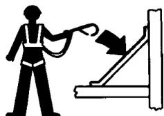
Il personale in piattaforma deve indossare una cintura o imbracatura di sicurezza in conformità alla normativa nazionale vigente. Fissare la corda di ancoraggio di sicurezza all'attacco presente sulla piattaforma.
