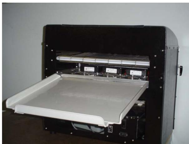
**Figura 13: Cassetto di raccolta delle stampe**
