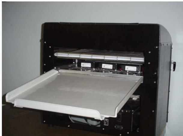
Figura 4: Cassetto di raccolta delle stampe
