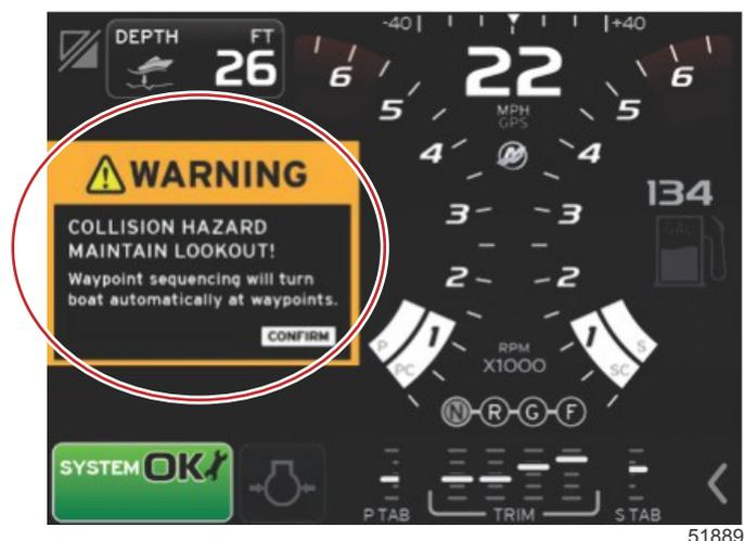
8. Prestare la massima attenzione. In questa modalità l'imbarcazione compie virate automaticamente. L'operatore deve sapere se è possibile eseguire una virata in sicurezza quando l'imbarcazione entra in una zona di arrivo a destinazione. Avvisare i passeggeri di tenersi pronti a una virata automatica dell'imbarcazione.
