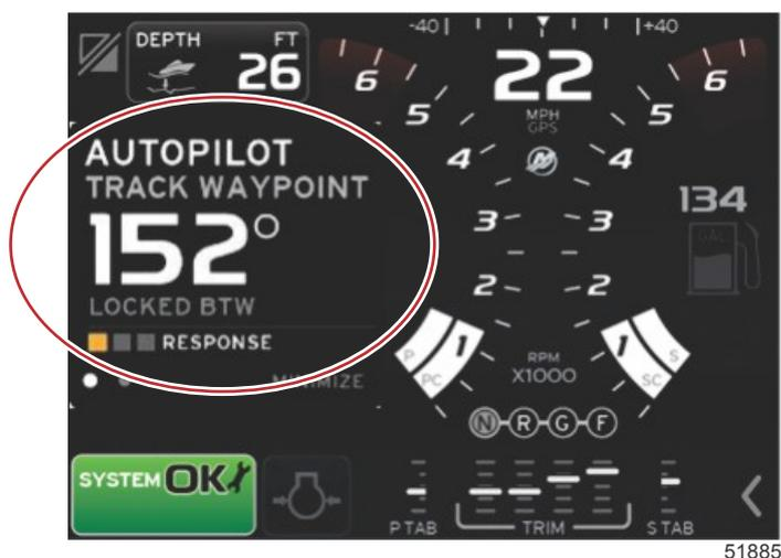
**NOTA:** quando la modalità di tracciato fino a destinazione è attiva, non è possibile virare utilizzando i pulsanti di virata del pannello frecce del pilota automatico; le funzionalità di virata sono disponibili solo in modalità di rotta automatica.
