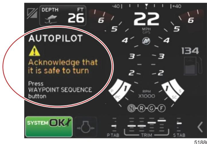
2. Se è possibile modificare la rotta in sicurezza verso la destinazione successiva, premere **WAYPOINT SEQUENCE (Sequenza di punti di destinazione)** per confermare la destinazione. L'imbarcazione virerà automaticamente tramite il pilota automatico e proseguirà lungo la nuova rotta.
