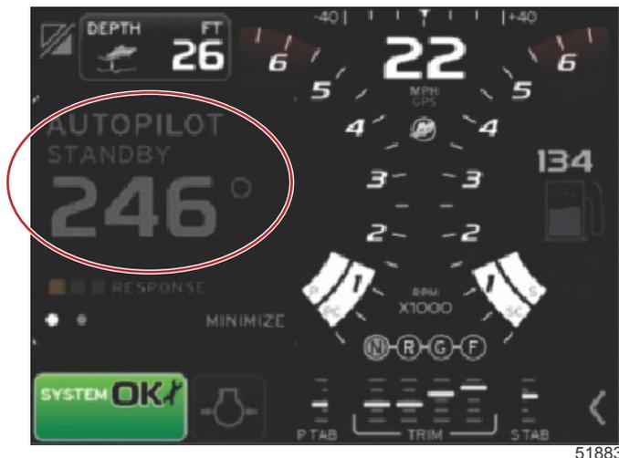
4. Se la spia di stand-by è illuminata e la spia di ripresa è spenta, non è possibile riprendere la rotta premendo il pulsante di ripresa. Fare riferimento a **Riprendere una rotta**. Premere il pulsante di rotta automatica per uscire completamente dalla modalità di rotta automatica.
