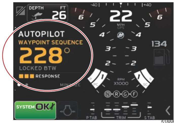
6. Se l'imbarcazione si trova in una zona di arrivo a destinazione impostata dal plotter cartografico, la modalità di sequenza di punti di destinazione si limita a notificare al pilota automatico che è possibile procedere fino alla destinazione successiva. La modalità di sequenza di punti di destinazione fornisce una conferma della destinazione e il pilota automatico emette un segnale acustico quando la zona è stata raggiunta.
