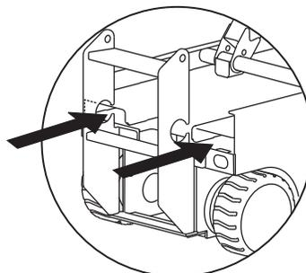
Posizionare le forche del carrello elevatore in corrispondenza degli appositi alloggiamenti.
