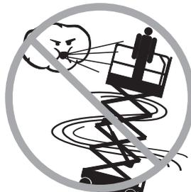
Non utilizzare la macchina con vento superiore ai 12,5 m/s o in presenza di raffiche di vento. Non aumentare la superficie o il carico della piattaforma. L'aumento della superficie esposta al vento diminuisce la stabilità della macchina.
