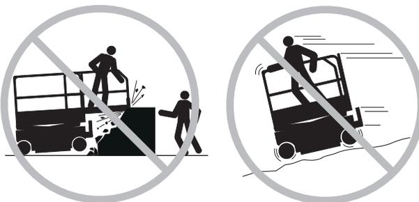
Ridurre la velocità di traslazione in base alle condizioni del suolo, alla situazione del traffico, alle pendenze, alla presenza di personale e ad altri fattori che possono essere causa di collisioni.
