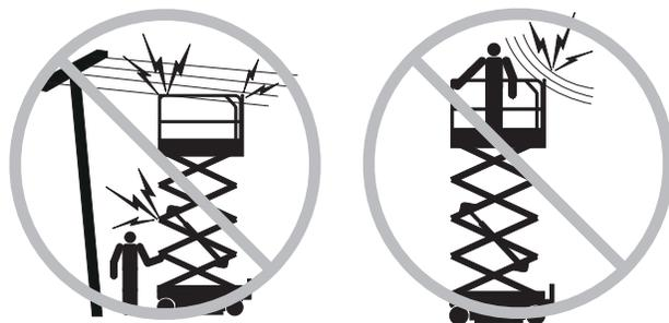
Mantenere la distanza di sicurezza dalle linee e dalle apparecchiature ad alta tensione secondo le normative nazionali vigenti e in base alla seguente tabella.
