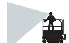
Fare attenzione in situazioni di scarsa visibilità e di punti ciechi durante la guida o il funzionamento della macchina.
