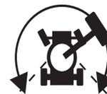
Per eseguire la traslazione, mantenere azionato l'interruttore abilitazione traslazione in una delle due posizioni laterali e spostare lentamente dal centro la manopola di comando traslazione.
