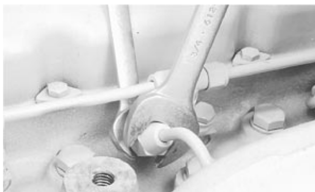
Disaerazione dell'impianto di alimentazione in corrispondenza degli ugelli d'iniezione
