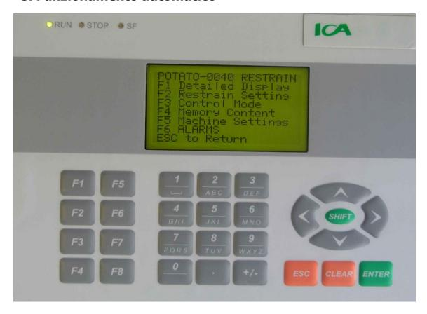
Il funzionamento del "Restrain Generator" viene visualizzato e controllato dal display e dal tastierino nella parte alta della macchina.
