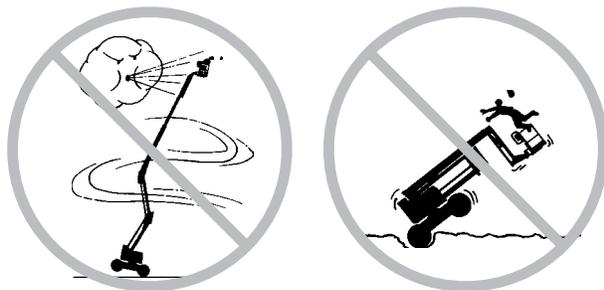
Utilizzare estrema cautela e velocità ridotta quando la macchina viene spostata in posizione retratta su superfici non livellate, instabili, con detriti o scivolose, e in prossimità di fossati e dirupi.
