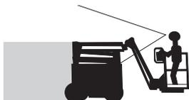
Fare attenzione in situazioni di scarsa visibilità e di punti ciechi durante la guida o il funzionamento.
