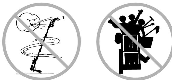
Il personale, le apparecchiature e il materiale non devono superare la capacità massima della piattaforma.
