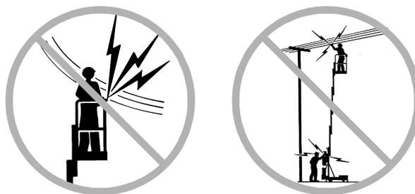
Non avvicinarsi alla macchina se questa viene a contatto con cavi elettrici sotto tensione o se risulta caricata elettricamente. Il personale a terra o sulla piattaforma non deve toccare o far funzionare la macchina fino a quando non è stata interrotta l'alimentazione alle linee elettriche.
