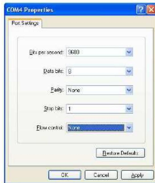
Figura 58 - Configurazione della porta COM4
