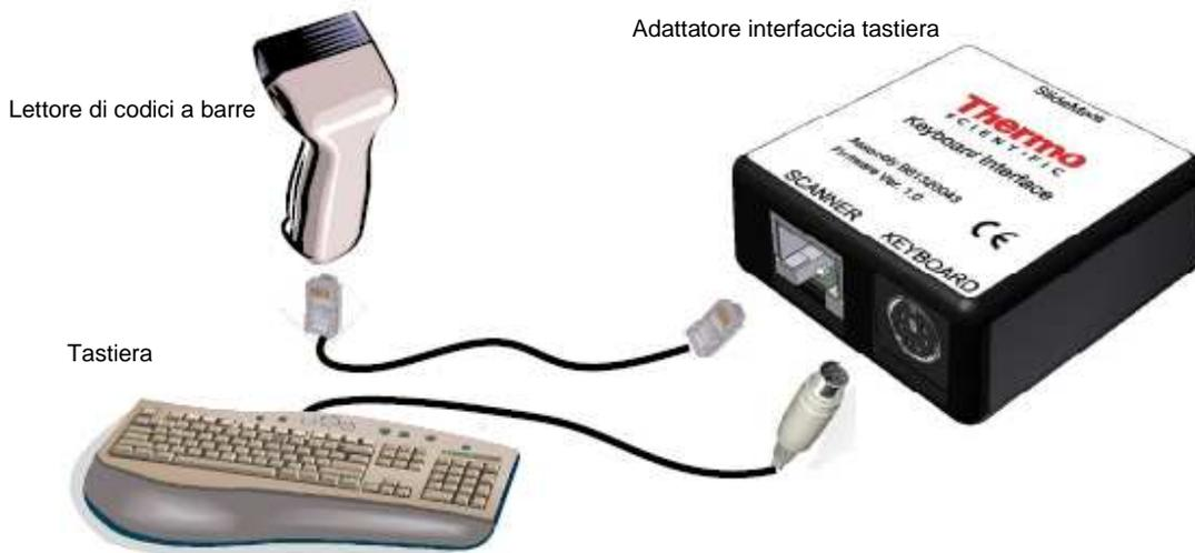
Figura 20 - Collegamento della tastiera e del lettore codici a barre
