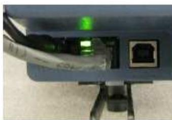
Figura 27 – LED del link in alto a sinistra
