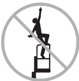
Non uscire dalla piattaforma quando si trova in posizione sollevata. In caso di interruzione dell'alimentazione, è necessario disporre di personale a terra per azionare la valvola di abbassamento manuale piattaforma.
