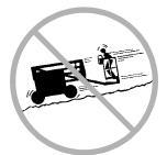
Ridurre la velocità di traslazione in base alle condizioni del suolo, del traffico, alle pendenze, alla presenza di personale e agli altri fattori che possono essere causa di collisioni.
