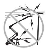
Mantenere la distanza di sicurezza dalle linee e dalle apparecchiature ad alta tensione secondo le vigenti normative nazionali e in base alla seguente tabella.
