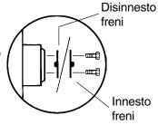
Modelli 4WD: rilasciare i freni ruotando i quattro coperchi di disinserimento mozzi di trasmissione.
