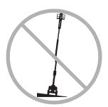
Prima di utilizzare la macchina, accertarsi che il terreno sia in grado di sostenere il peso della macchina. Il carico massimo di ogni pneumatico è indicato nelle specifiche tecniche del manuale.
