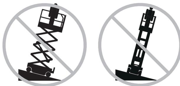
Non utilizzare l'allarme di inclinazione come indicatore di livello. L'allarme inclinazione suona sullo chassis e in piattaforma se la macchina si trova in pendenza.
