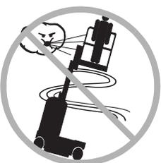
Non utilizzare la macchina in presenza di vento. Non aumentare la superficie o il carico della piattaforma. L'aumento della superficie esposta al vento diminuisce la stabilità della macchina.
