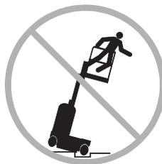
Utilizzare estrema cautela e velocità ridotta quando la macchina viene spostata in posizione retratta su superfici non livellate, instabili, con detriti o scivolose, e in prossimità di fossati e dirupi.
