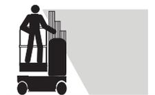
Fare attenzione in situazioni di scarsa visibilità e di punti ciechi durante la guida o il funzionamento della macchina.
