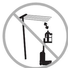
Mantenere la distanza di sicurezza dalle linee elettriche e dalle apparecchiature ad alta tensione secondo le vigenti normative nazionali e in base alla seguente tabella.
