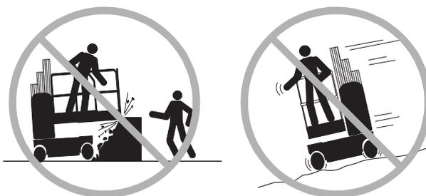
Ridurre la velocità di traslazione in base alle condizioni del suolo, alla situazione del traffico, alle pendenze, alla presenza di personale e ad altri fattori che possono essere causa di collisioni.
