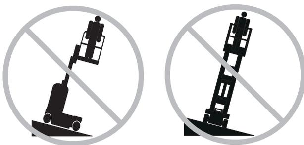
Non utilizzare l'allarme di inclinazione come indicatore di livello. L'allarme di inclinazione suona solo quando la macchina si trova su una pendenza.
