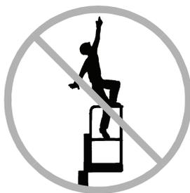
Non uscire dalla piattaforma quando è in posizione sollevata. In caso di interruzione dell'alimentazione, è necessario disporre di personale a terra per azionare la valvola di abbassamento manuale piattaforma.
