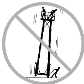
Sollevare la piattaforma soltanto quando la base è livellata con tutti e quattro i bracci estensibili della base correttamente installati e i martinetti di livellamento saldamente a contatto con il suolo.
