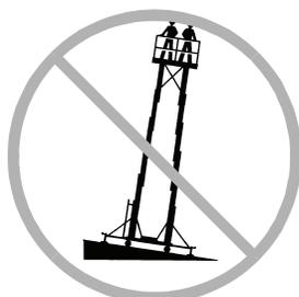
Non sollevare la piattaforma se la macchina non è livellata. Non posizionare la macchina su superfici su cui non è possibile regolare il livellamento utilizzando soltanto gli appositi martinetti. Non utilizzare fermi di arresto, blocchi o spessori di qualsiasi tipo per livellare la macchina.
