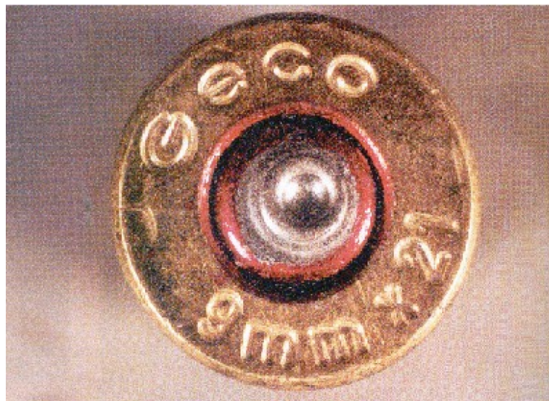
Bossolo esploso da una Beretta modello 98. Si noti l'inconfondibile anello di Saturno che contraddistingue i bossoli esplosi dalle pistole di quel tipo.
