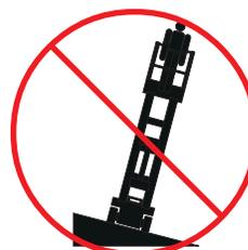
Non utilizzare l'allarme di inclinazione come indicatore di livello. L'allarme di inclinazione suona all'interno del vano caricabatterie solo quando la macchina si trova su una forte pendenza.
