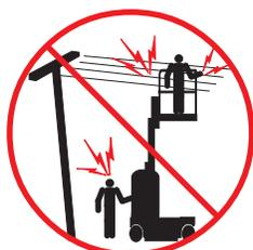
La macchina non è elettricamente isolata e non fornisce protezione dal contatto o dalla prossimità a linee elettriche.
