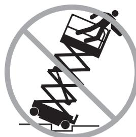
Utilizzare estrema cautela e velocità ridotta quando la macchina viene spostata con la piattaforma retratta su superfici non livellate, instabili, con detriti o scivolose, e in prossimità di fossati e dirupi.
