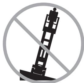
Non utilizzare l'allarme di inclinazione come indicatore di livello. L'allarme di inclinazione suona sullo chassis solo quando la macchina si trova su una forte pendenza.
