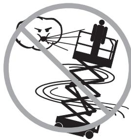
Non utilizzare la macchina con vento superiore ai 12,5 m/s o in presenza di raffiche di vento. Non aumentare la superficie o il carico della piattaforma. L'aumento della superficie esposta al vento diminuisce la stabilità della macchina.
