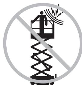
Allontanarsi dalla macchina in caso di contatto con linee elettriche sotto tensione. Il personale a terra o sulla piattaforma non deve toccare o far funzionare la macchina fino a quando non è stata interrotta l'alimentazione alle linee elettriche.
