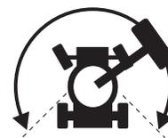
Nota: se il sistema di abilitazione traslazione è in uso, la macchina può eseguire la traslazione nella direzione opposta rispetto alla direzione in cui viene spostata la manopola di comando traslazione e sterzata.
